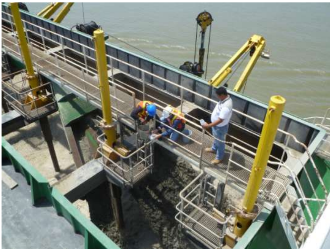
Fotografía 9. Recolección de muestras de sedimentos en una de las tolvas de la Draga “Francisco de Orellana”, durante el proceso de dragado.
