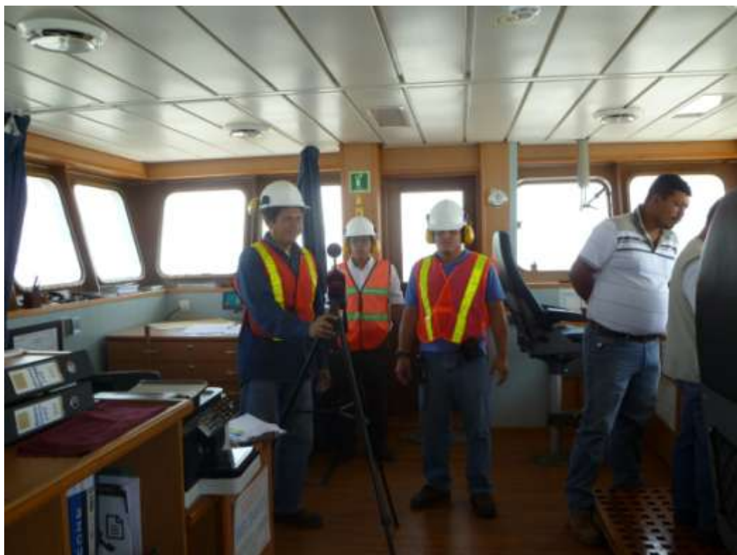
Fotografía 8. Personal del Centro de Estudios del Medio Ambiente CEMA-ESPOL realizando mediciones de ruido en el puente de mando de Draga “Francisco de Orellana”.
