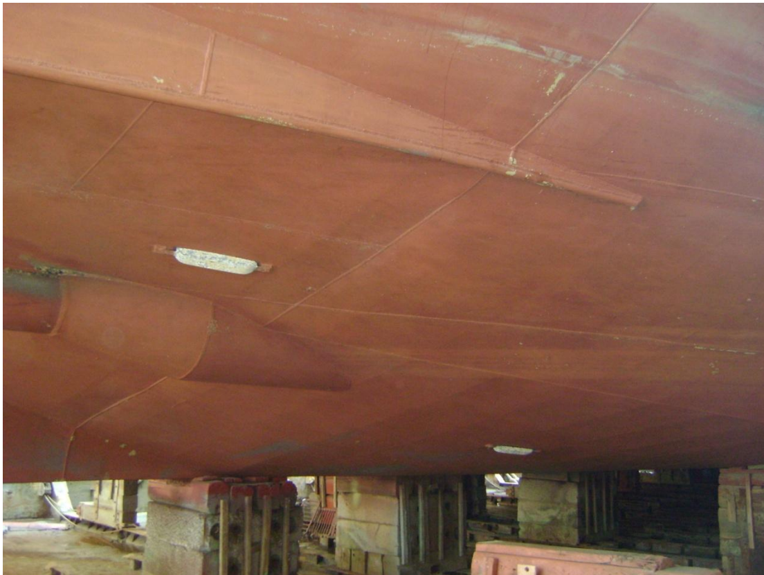
Fotografía 4. Vista general de distribución de ánodos de sacrificio (panes de zinc) para control de la corrosión del casco de la DRAFOR.
