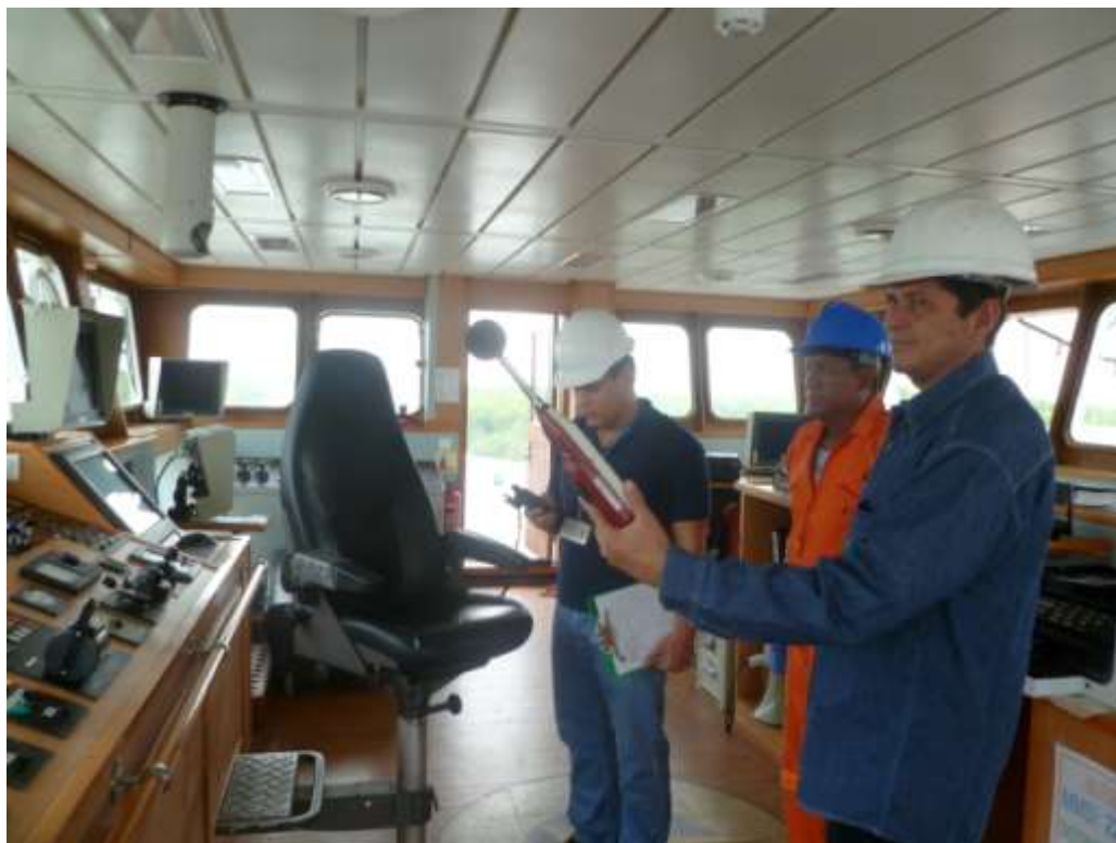
Fotografía 1. Personal del CEMA-ESPOL durante el monitoreo de medición de ruido abordo de draga Francisco de Orellana, en el Dique de la Armada del Ecuador.
