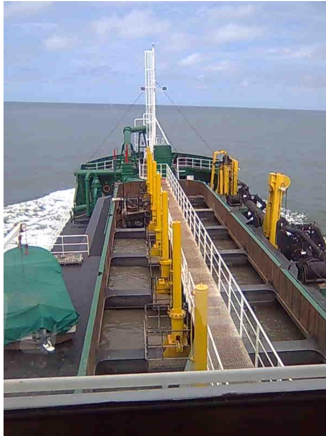
Fotografía 3. Draga con tolvas llenas de material extraído en sector de Boyas 48 a 51.
